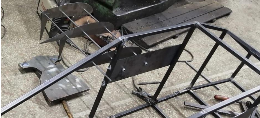
Şekil 2. Kanadın şasiye somunlar ile montajlanmış hali (Kavak, 2022).
